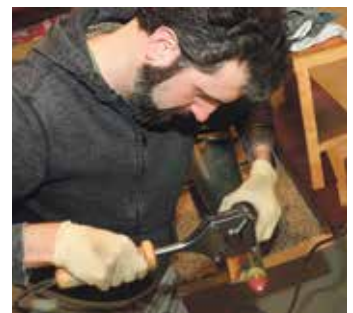
Die kaputten konischen Zapfen der Orgelpfeifen werden abgetrennt und durch neue Konussteckteile in sorgfältiger Handarbeit wieder aufgelötet
